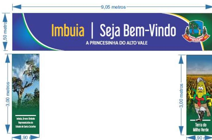
Chapa de ACM 0,20 3mm com vinil de alta durabilidade em impressão digital e aplicação de verniz automotivo Lazzuril 7100 com adição de flexibilizante. Conforme medidas especificadas.
