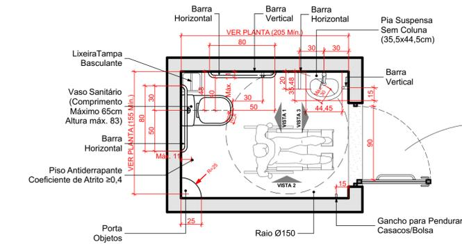
OBSERVAÇÕES: O DIMENSIONAMENTO DO BANHEIRO (MEDIDAS MÍNIMAS) TEM RELAÇÃO COM AS LOUÇAS SANITÁRIAS UTILIZADAS, DEVENDO ASSIM SER RESPEITADAS, PODENDO VARIAR APENAS 5 CENTÍMETROS NA LARGURA, A PIA PODE VARIAR EM SUA ALTURA, SENDO A MÁXIMA 16,5 cm.
